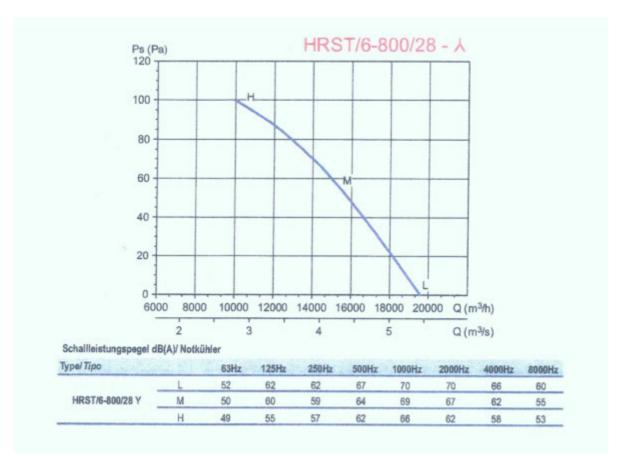
Der zum 190 kW<sub>el</sub>- Motor gehörende Notkühler AIA XP 90, Modell 4 ist an der westlichen, von der Wohnbebauung abgeschirmten Gebäudefassade in einer Höhe von ca. 4,5 m angeordnet. Die schalltechnischen Kenndaten sind nachfolgend wiedergegeben. Demzufolge ist ein Schalldruckpegel von 60 dB(A) in einer Entfernung von 10 m bzw. ein Schallleistungspegel von 92 dB(A) vorgegeben (s. Standort 2 "AIA" im Planausschnitt M 1:250 der Anlage 1).
